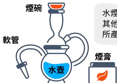
水煙壺是吸水煙的器具，主要包括頂部盛載煙膏和煤炭的煙碗、底部盛載水或其他液體的水壺、及連接至吸煙人士的軟管。燃燒煙碗上的煤炭將煙膏加熱，所產生的煙霧會先經過水壺，再經由軟管傳送至吸煙人士。
