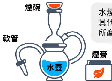
水煙壺是吸水煙的器具，主要包括頂部盛載煙膏和煤炭的煙碗、底部盛載水或其他液體的水壺、及連接至吸煙人士的軟管。燃燒煙碗上的煤炭將煙膏加熱，所產生的煙霧會先經過水壺，再經由軟管傳送至吸煙人士。
